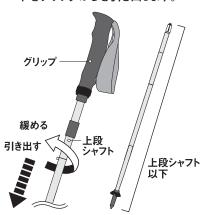
②上段シャフト上部の古い脱落防止用パーツ(ワッシャー)を図のように横方向にずらして取り外します。
