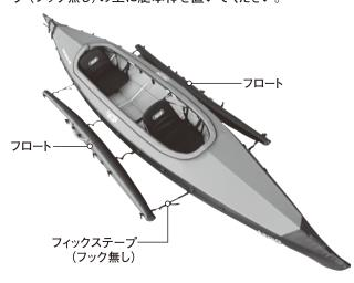
4フロートの上側のメスバックルにフィックステープの オスバックルを接続します。コーミングカバーの 装着有無によって、フィックステープの種類と 取り付け位置が異なります(下記参照)。
