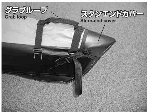
防水カバーの口部分のナイロンテープを芯にするようにしてベルクロテープの付いている面が上を向くまでカバーを巻き込み、もう一方のフラップのベルクロテープと合わせるようにセットします。
