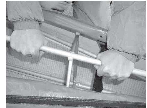
DRパイプ先端のピンをリブ4の頂点の穴へ差し込み、ジョイントピンで固定します。次に、DRパイプをリブ5へ取り付けます。
