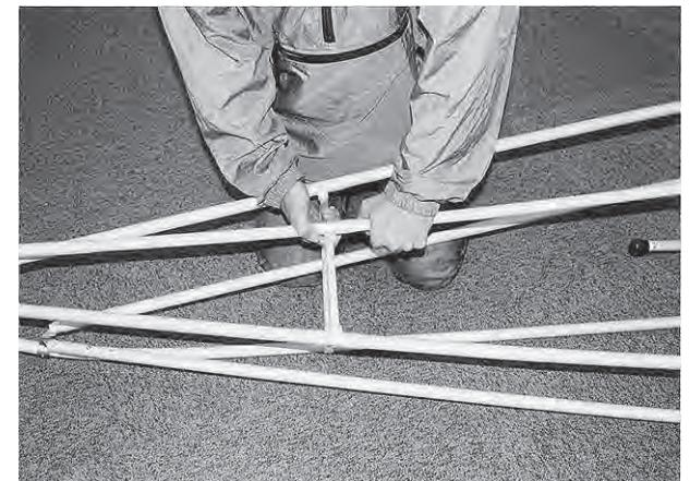
Kパイプ先端の可動パーティ( TB-Fパイプ)にDFパイプのピンの無い方を差し込み、リブ3上部の穴にDFパイプの先端ピンを奥まで差し込みます。
