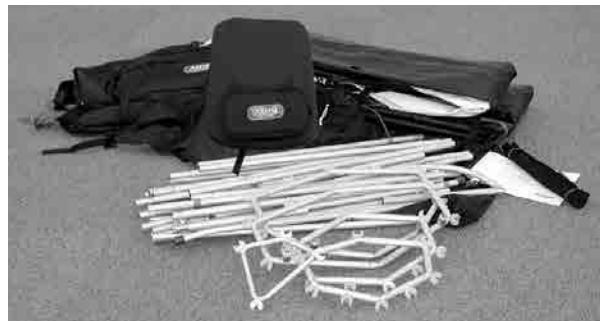
○フォールディングカヤックは最初の組み立てが肝心です。船体布にテンションを掛けエアチューブに空気を入れると船体布には強力なテンションが掛かります。そして船体布が少しのびてフレームに馴染みます。もしフレームが歪んでいたり、船体布の中心がずれたまま組み上げてしまうと、歪みくせの付いた船体布になってしまいますので最初の組み立ては慎重に行ってください。歪みの無い組み立てができたら1日程度、組み立てたままにして船体布をフレームに馴染ませてください。こうすることによって次の組み立てがより簡単に正確になります。
