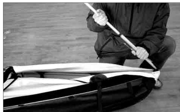
テンションロープの片側を上図のように本テンション取付点に掛け直し、TB-Rパイプをゆっくりと起こします。次にTB-RパイプにDRパイプを取り付けます。DRパイプをTB-Rパイプの一番奥まで差し込んだ状態でDRパイプを倒してください。
