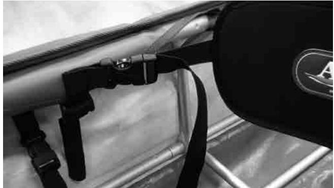
シート背面の前側のテープをコーミング内側のバックルへ取り付け、テープの張り具合でシート背面の位置を調整します。
