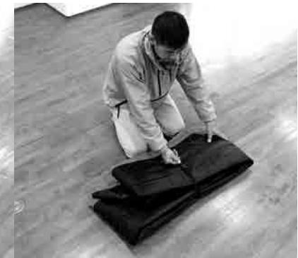
コーミングを船体布の中心から左端までずらしておきます。右側の部分を折り返してコーミングの上に載せるようにたたみます。次にコーミングの前端、後端に合わせて前後を折りたたみます。さらにコンパクトにしたい場合は、コーミング芯材をネオプレンのケースから取り出して船体布をたたみます。コーミング芯材は、2分割になっていますがネオプレンのケースごと2つ折にしないでください。ネオプレンのケースが破損する場合があります。
