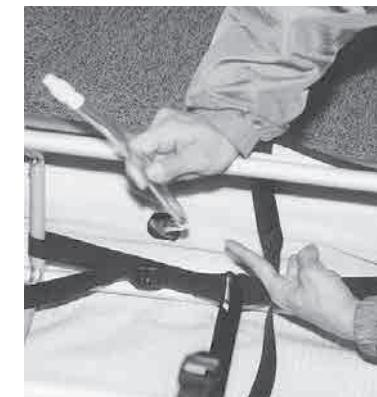
船体布を広げ、フレーム前後を間違わないように注意しながら船体布に入れます。必ずこれ以上入らないという所までしっかり押し込んでください。この時、キールレール(ボトム内側の中央にある溝)にKパイプを合わせて、センターがずれないように注意してください。
