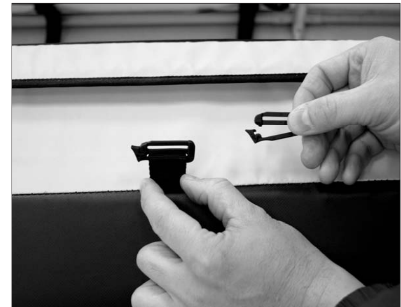
(20) スリッククリップの取り付け
