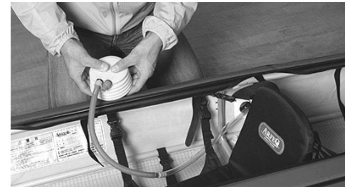
シート背面の前側のテープをコーミング内側のバックルへ取り付け、テープの張り具合でシート背面の傾斜を調整します。
