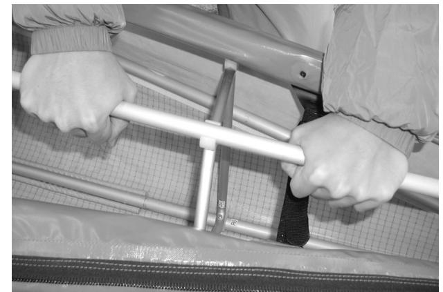
DRパイプ先端のピンをリブ5の頂点の穴へ差し込み、ジョイントピンで固定します。次に、DRパイプをリブ6へ取り付けます。
