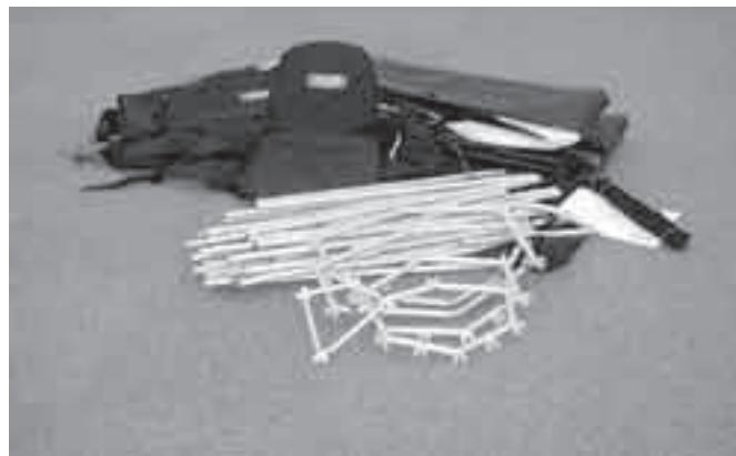
○フォールディングカヤックは最初の組み立てが肝心です。船体布にテンションを掛けエアチューブに空気を入れると船体布には強力なテンションが掛かります。そして船体布が少しのびてフレームに馴染みます。もしフレームが歪んでいたり、船体布のセンターがずれたまま組み上げてしまうと、歪みくせの付いた船体布になってしまいますので最初の組み立ては慎重に行いましょう。歪みの無い組み立てができたら1日程度、組み立てたままにして船体布をフレームに馴染ませましょう。こうすることによって次の組み立てがより簡単に正確になります。
