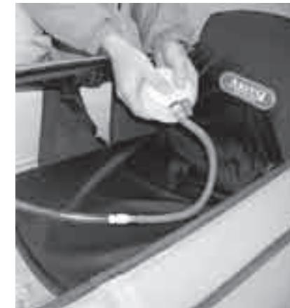
シート背面の前側のテープをコーミング内側のバックルへ取り付け、テープの張り具合で傾斜を調整します。エアホースの先端にあるバルブを開き、エアポンプのホースにしっかりと差し込み、空気を入れます。
