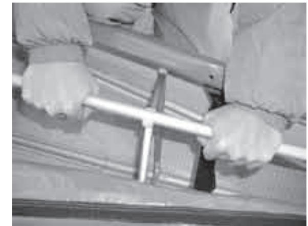
DRパイプ先端のピンをリブ4の頂点の穴へ差し込み、ジョイントピンで固定します。次に、DRパイプをリブ5へ取り付けます。その後、セール裏面のデッキとボトムの生地の溶着部分をGパイプの上へ引き上げます。
