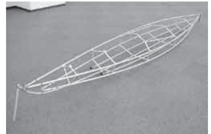
リブ2のチャンネル(三日月型の部品)へKSパイプの直線部分の始まりを取り付けます。この時、曲がっている方(ゴムキャップ)が艇の内側を向くように注意してください。そのままリブ3・4・5へ取り付けます。KSパイプの後端も内側を向けて取り付けてください。
