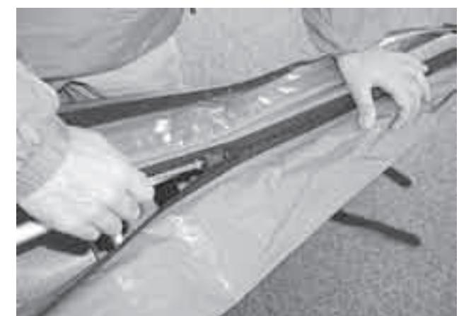
コーミングベルトがGパイプの上になっている事を確認し左右均等に締めます。(断面図参照)
