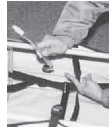
セールを広げ、フレーム前後を間違わないように注意しながらセールに入れます。必ずこれ以上入らないという所までしっかり押し込んでください。この時、キールレール(ボトム内側の中央にある溝)にKパイプを合わせて、センターがずれないように注意してください。
