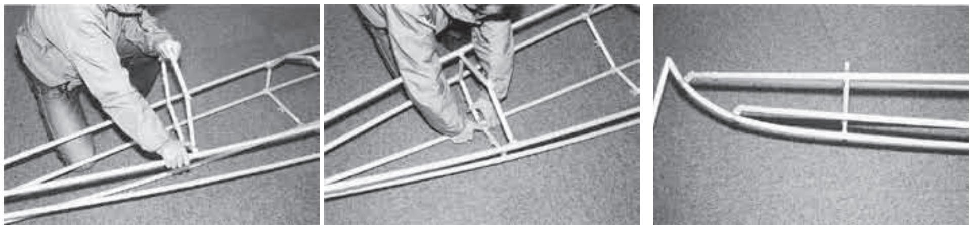
リブ2・5をGパイプ・Eパイプの各リブ取り付け溝(Kパイプのステッカー『2』『5』と同位置にあります)へそれぞれ取り付け、そのままKパイプに取り付けます。次に、リブ1をGパイプのリブ1取り付け溝へ取り付け、リブがGパイプとほぼ直角になるようにKパイプへ取り付けます。
