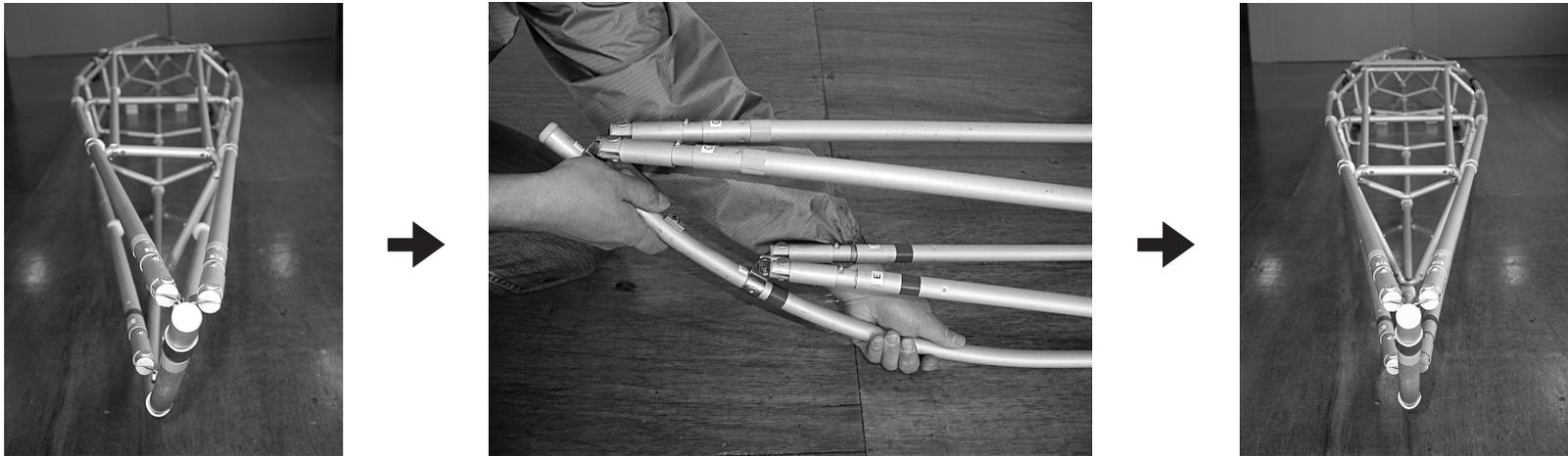
真上から見てKパイプが一直線上になれば、先端が左右どちらかに倒れていますので、軽くたたいて修正してください。
