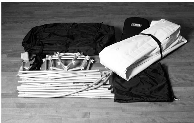
○フォールディングカヤックは最初の組み立てが肝心です。船体布にテンションを掛けエアチューブに空気を入れると船体布には強力なテンションが掛かります。そして船体布が少しのびてフレームに馴染みます。もしフレームが歪んでいたり、船体布のセンターがずれたまま組み上げてしまうと、歪みくせの付いた船体布になってしまいますので最初の組み立ては慎重に行いましょう。歪みの無い組み立てができたなら1日程度、組み立てたままにして船体布をフレームに馴染ませましょう。こうすることによって次の組み立てがより簡単に正確になります。
