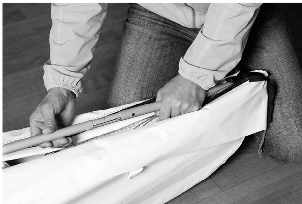
DR(3)パイプ先端のピンをリブ6の頂点の穴へ差し込み、ジョイントピンで固定します。その後、船体布裏面のデッキとボトムの生地をGパイプの上へ引き上げます。
