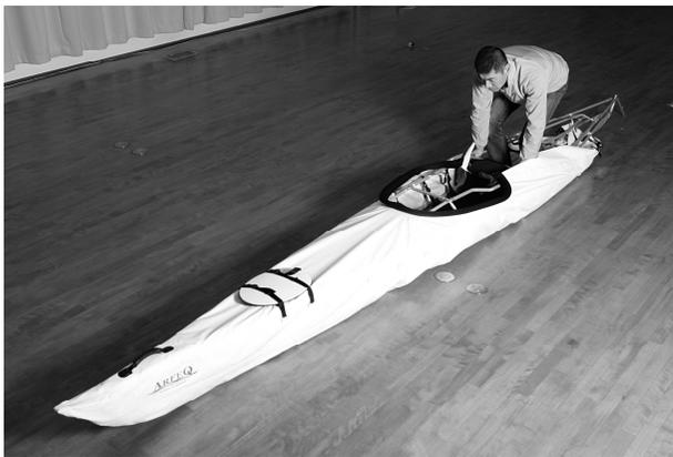
船体布を広げ、フレーム前後を間違わないように注意しながら船体布に入れます。必ずこれ以上入らないという所までしっかり押し込んでください。この時、キールルール(ボトム内側の中央にある溝)にKパイプを合わせて、センターがずれないように注意してください。
