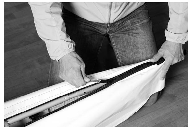
コーミングベルトがGパイプの上になっている事を確認し左右均等に締めます。(断面図参照)
