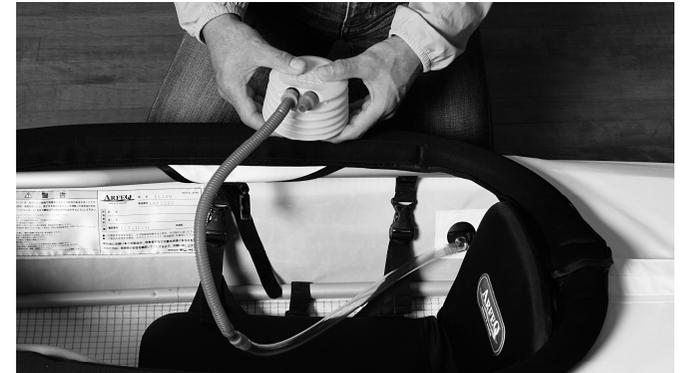
シート背面の前側のテープをコーミング内側のバックルへ取り付け、テープの張り具合でシート背面の傾斜を調整します。エアホースの先端にあるバルブを開き、エアポンプのホースにしっかりと差し込み、空気を入れます。艇を上から見て3cm～4cm程度ふくらんだ状態が標準です。(図1)
