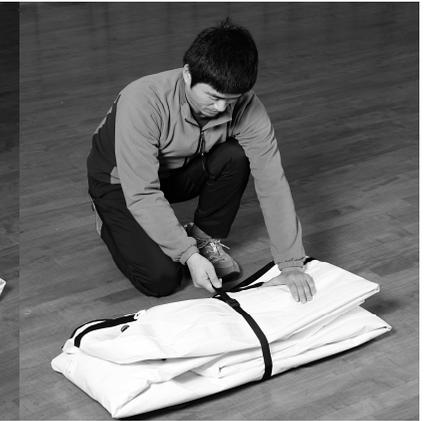
コーミングを船体布の中心から左端までずらしておきます。右側の部分を折り返してコーミングの上に載せるようにたたみます。次にコーミングの前端、後端に合わせて前後を折りたたみます。さらにコンパクトにしたい場合は、コーミング芯材をネオプレンのケースから取り出して船体布をたたみます。コーミング芯材は、2分割になっていますがネオプレンのケースごと2つ折にしないでください。ネオプレンのケースが破損する場合があります。
