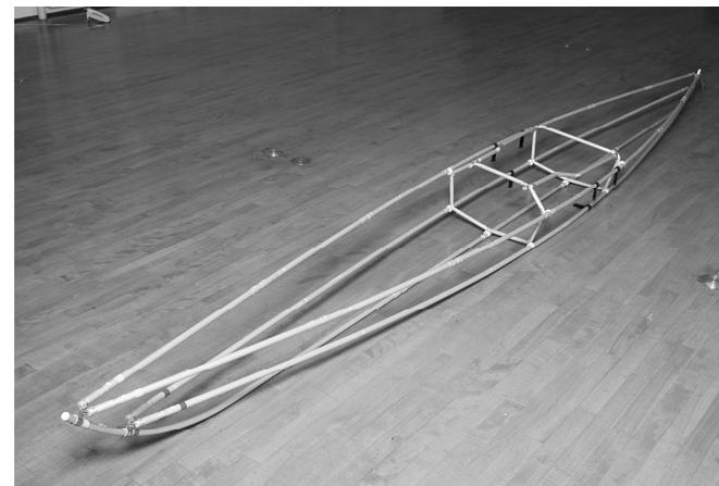
Gパイプと同様にEパイプを取り付けます。取り付け位置はKパイプと並べて確認してください。
