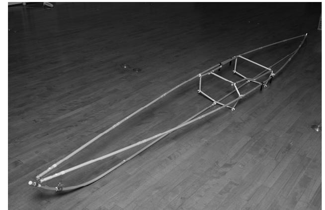
Aタンク（虫の翼のような金具）にGパイプ先端を取り付けます。膝の上にKパイプをのせて、適度な反りがついた状態でおこないます。一方の手でGパイプを引き寄せ、もう一方の手で金具の傾き調整、スライド操作をおこなってください。
