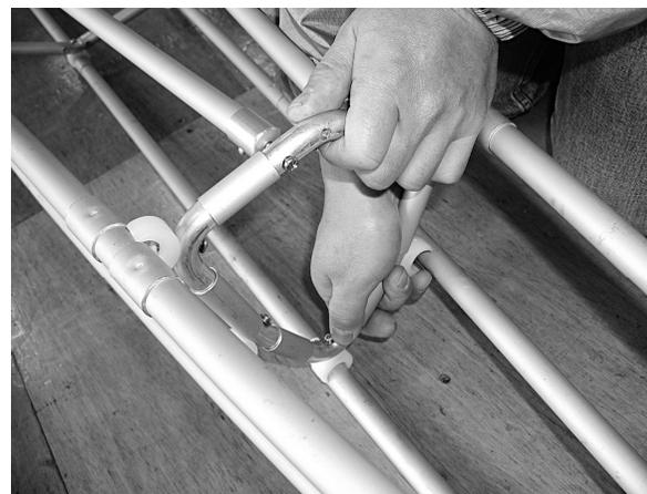
DFパイプと同様の手順でDRタイプを取り付けます。リブ4のDRパイプ取付金具にジョイントピンで固定してください。次にDRパイプのもう一方をリブ6のDRパイプ取付金具にジョイントピンで固定してください。その後リブ6をGパイプのリブ取付溝に取り付けます。リブ6がKパイプとほぼ直角になるようにKパイプに取り付けた後、リブ5にDRパイプを固定します。
