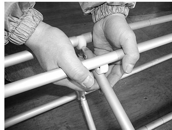
次にDFパイプのもう一方をリブ1のDFパイプ取付金具にジョイントピンで固定してください。その後リブ1をGパイプのリブ取付溝に取り付けます。リブ1がKパイプとほぼ直角になるようにKパイプに取り付けた後、リブ2にDFパイプを固定します。
