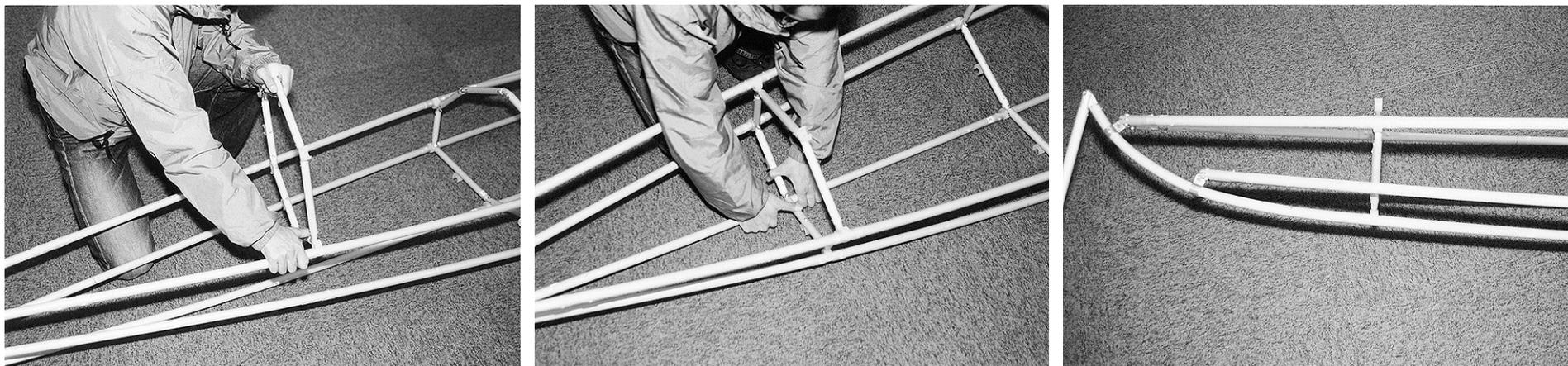
リブ2・3・6・7をGパイプの各リブ取り付け溝（Kパイプのステッカー『2』『3』『6』『7』と同位置にあります）へそれぞれ取り付け、そのままKパイプのリブ取り付け溝へ取り付けます。次に、Eパイプをリブ2・3・6・7へ取り付けます。その後、リブ1をGパイプのリブ1取り付け溝に取り付け、リブがGパイプとほぼ直角になるようにKパイプへ取り付けます。
