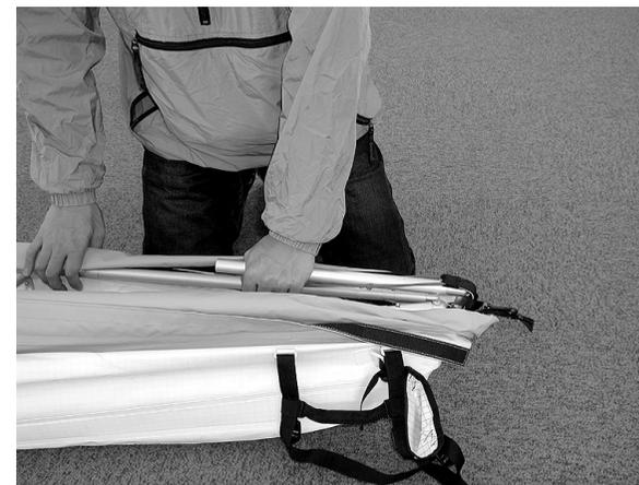
そのままゆっくりとTB-Rパイプを起こしていきます。この時、Kパイプがセールのセンターと合うように調整しながらTB-Rパイプを水平になるくらいまで倒します。
