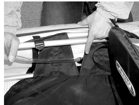
セールを広げ、フレーム前後を間違わないように注意しながらセールに入れます。必ずこれ以上入らないという所までしっかり押し込んでください。この時、キールレール(ボトム内側の中央にある溝)にKパイプを合わせて、センターがずれないように注意してください。
