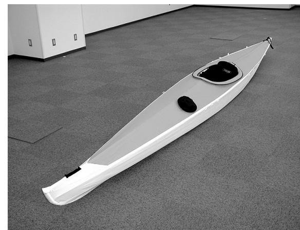
防水カバーの口部分のナイロンテープを芯にするようにしてマジックテープの付いている面が上を向くまでカバーを巻き込み、もう一方のフラップのマジックテープと合わせるようにセットします。次に、Grabループ、スタンエンドカバーをセットしてください。
