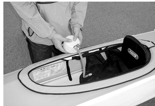
シート背面の前側のテープをコーミング内側のバックルへ取り付け、テープの張り具合で傾斜を調整します。エアホースの先端にあるバルブを開き、エアポンプのホースにしっかりと差し込み、空気を入れます。
