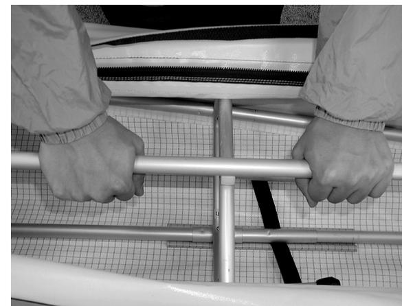
DRパイプ先端のピンをリブ5の頂点の穴へ差し込み、ジョイントピンで固定します。次に、DRパイプをリブ6・7へ取り付けます。その後、セール裏面のデッキとボトムの生地をGパイプの上へ引き上げます。
