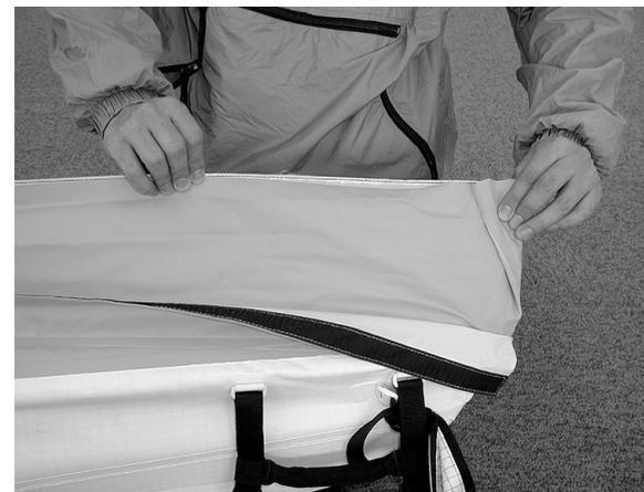
ファスナーの端の部分を折り込みます。次に、左右2枚の防水カバーの生地を重ねて、角を内側に折り込みます。
