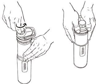
③浄水時の圧力を逃がすために飲み口のキャップを半回転緩め、体重をかけてゆっくりと下に向けて押し込みます。約10秒で浄水が完了します。※実際の浄水にかかる時間は、水質、カートリッジ使用回数、水温、使用者の使い方によって異なります。
