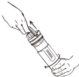
①キャップのハンドルと、アウターボトルを片手ずつ持ち引き抜きます。ひねりを加えると外しやすくなります。
