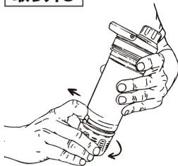
インナープレスの下部にある浄水カートリッジのロックタブを引き出し、時計回りに回して浄水カートリッジを外します。
