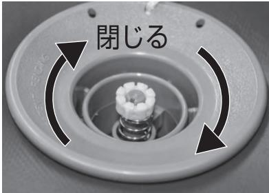
バルブの中央を押し込みながら、左右どちらかに回し、バルブ中央を下げる。
