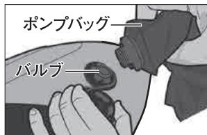
③ポンプバッグの2箇所のハンドルを持ちながら、上下に揺らしてバッグの内部に空気を溜めます。空気が入ったらハンドルを合わせて、ポンプバッグを巻き込みながら艇本体に空気を入れます。艇本体が膨らむまで、この動作を繰り返します。
