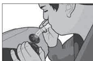
⑤残りの空気は、インフレーションチューブをバルブに差し込み、口で吹き込みます。可能な限り空気を入れてください。口で吹き込む場合は空気圧が上がり過ぎることはありません。ポンプを使う場合は2.0psiまで入れてください。それ以上の空気は絶対に入れないでください。
