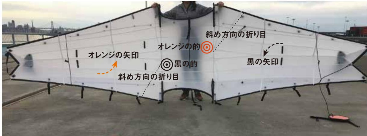
取り外し可能なパーツをすべて外したら、広げたハルにある斜め方向の折り目を見つけてください。(写真点線参照)次に、黒とオレンジの矢印と的を見つけてください。次のステップでは、これらを目印として、アコーディオンのようにバウとスターンをカヤックの内側に折り込みます。
