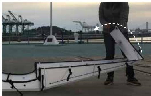
7 取り外し可能なパーツをすべて取り外したら、片側の端を写真のようにV字になるよう内側に折り込みます。
