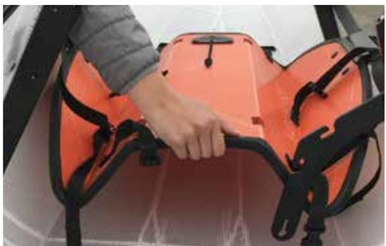
6 写真のようにフロアボードのセンターを引き上げながら取り外します。
