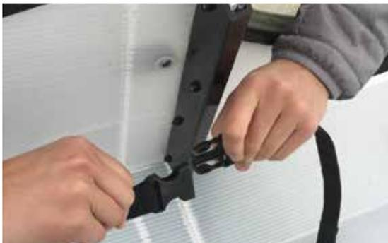
5 2つのスターン側バルクヘッドを取り外します。更にフットレストバックルを外してバウ側のバルクヘッドを取り外します。
