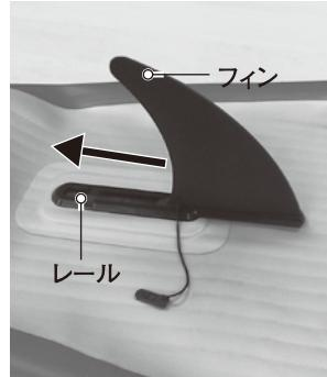
ボードのボトム側のレールにフィンを図のように差し込みます。
