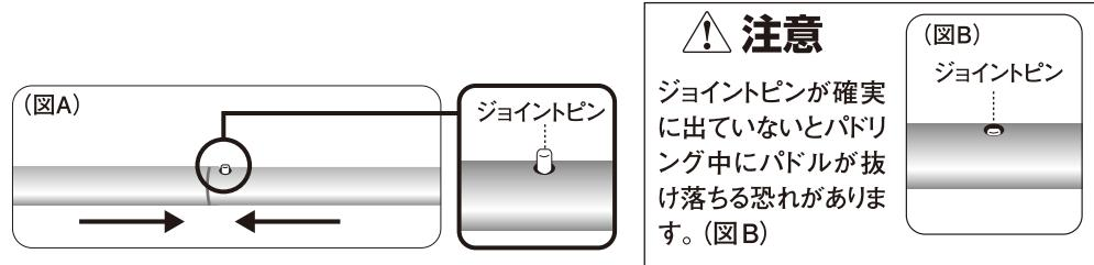
②上部と中部をつなげます。その際、長さ調節パーツのレバーを上げて長さを調節してください。
