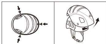
シールドは3本のビスにより本体に固定します。硬貨や付属のコイン型スクレュードライバーを用いてビスの着脱を行なってください。このとき1本のビスに対して一気に締め上げたり緩め切ったりせず、3本交互に少しずつ回してください。過度の締め上げはシールドやビス穴の破損を招きますので注意してください。
