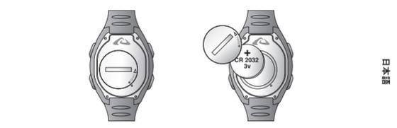
**注:** バッテリーを交換するときは、時計が完全防水になるように細心の注意を払ってください。バッテリーが適切に交換できなかったり、バッテリードアが正しく密閉できなかった場合、時計が破損する原因となり、保証が無効になる場合があります。
