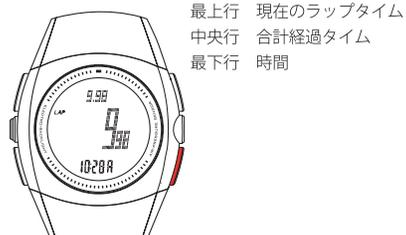
2. 1回のラップを計測するには、**START/SPLIT**キーを**押し**てください。画面に次のように表示されます。
