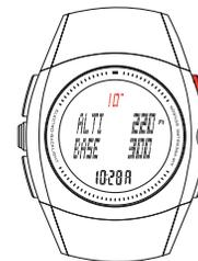
4. また滑降を開始するには、現在のベース高度を使用するために**START/SPLIT**キーを押し、自動または手動のベース高度保管手順を開始します。
