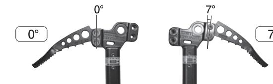
氷壁が急傾斜の場合、ピックの角度は下向きの方が威力を発揮しますので、ヘッドの一方で7度の差をつけています。状況に応じて使い分けてください。
