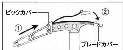
①ピックカバーを先端側からスライドさせて装着します。
