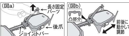
②靴とアイゼンの前後に隙間が無いように、靴の長さに合わせてアイゼンの後爪を動かして調節します(図b)。
