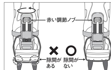
④アイゼンと靴底に隙間がある時には、赤い調節ノブを矢印の方向に回して隙間がなくなるようにしてください。
