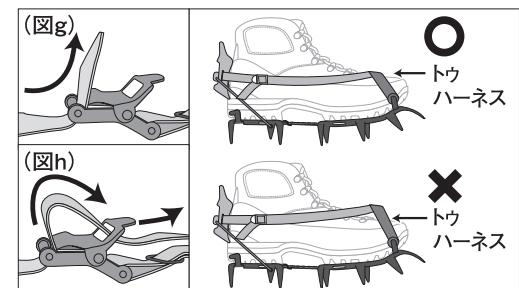
⑤ バックルにテープを(図g)のように通し、アイゼンのトウハーネスが靴に密着するようにテープを調節し、(図h)のようにテープをバックルに通して締めます。
