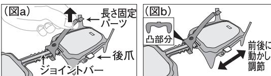
②靴とアイゼンの前後に隙間が無いように、靴の長さに合わせてアイゼンの後爪を動かして調節します(図b)。
