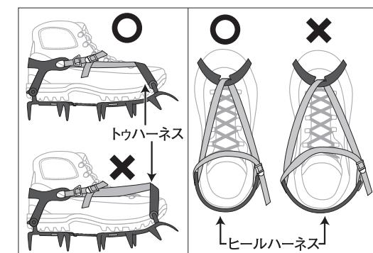
④バックルにテープを(図f)のように通し、アイゼンのトウハーネスとヒールハーネスが靴に密着するようにテープを調節し、(図g)のようにテープをバックルに通して締めます。
