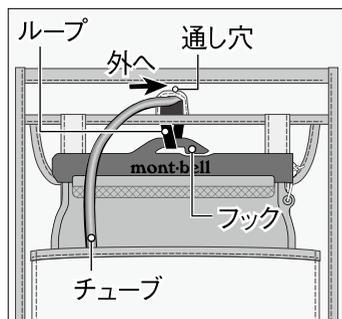
トレールウォーターパックのスライドパーツのフックを荷室内上部の図のループに掛けて装着し、図の通し穴からバックパックの外にチューブを出します。
