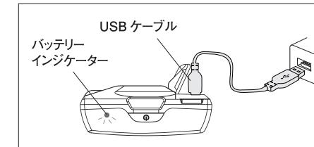
カバーを開け、付属のUSBケーブルを本体のUSBポートと給電が可能なUSBポートに挿します。接続すると自動的に充電を開始し、充電インジケーターが点灯します。充電インジケーターが消灯したら充電完了です。満充電までの時間は約2~3時間です。
