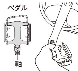
①ペダルの軸を持ち、硬くなるまで反時計回りに締め込んでいきます。初めから硬い場合はペダルが斜めになっている場合がありますので、やり直してください。
