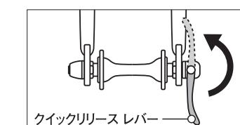
④クイックリリースレバーをCLOSEの刻印が見える位置へ力を入れて倒します。
