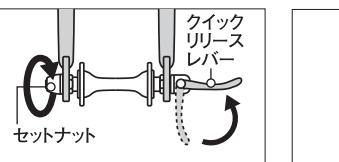
②クイックリリースレバーを半分ぐらい閉じた位置で固くなるようセットナットを時計回りに締めて調整します。
