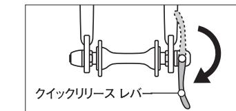
①ハブのクイックリリースレバーをOPENの刻印が見える位置へ倒します。
