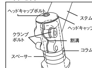
①ヘッドキャップボルトを緩めヘッドキャップを取り外す。
