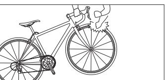
③クイックリリースレバーを一旦おろし自転車を浮かせ、車輪を強く叩き、車輪が外れないか確認してください。この時車輪が外れる場合、②に戻りセットナットをさらに締めます。
