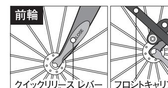
⑤前輪のクイックリリースレバーは前フォークと平行に、後輪のクイックリリースレバーは進行方向へ倒してください。ただし、フロントキャリアを取り付けた状態ではキャリアと平行に倒してください。
