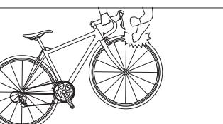
③クイックリリースレバーを一旦おろし自転車を浮かせ、車輪を強く叩き、車輪が外れないか確認してください。この時車輪が外れる場合、②に戻りセットナットをさらに締めます。
