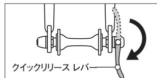
①ハブのクイックリリースレバーをOPENの刻印が見える位置へ倒します。
