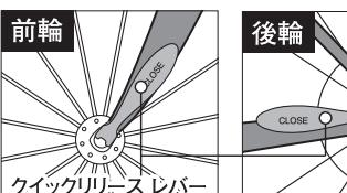
⑤前輪のクイックリリースレバーは前フォークと平行に、後輪のクイックリリースレバーは進行方向へ倒してください。
