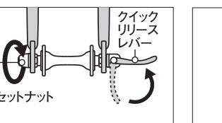
②クイックリリースレバーを半分ぐらい閉じた位置で固くなるようセットナットを時計回りに締めて調整します。
