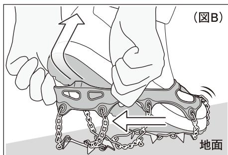
③装着後、バンドの後ろのタブをもう一度、上方向に引き、靴底のチェーンがしっかり張る（たるまない）ように伸ばします（図C）。チェーンの張りが無いと、制動力が落ちたり、木の根や枝に引っかかる恐れがあります。
