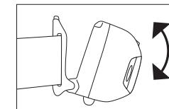
本体を上下に動かし、LEDの照射角度を調節します。
