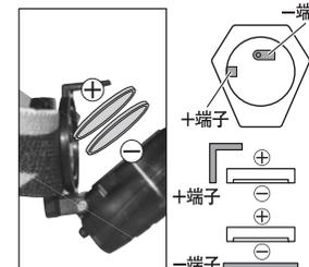
電池挿入口の閉め方
