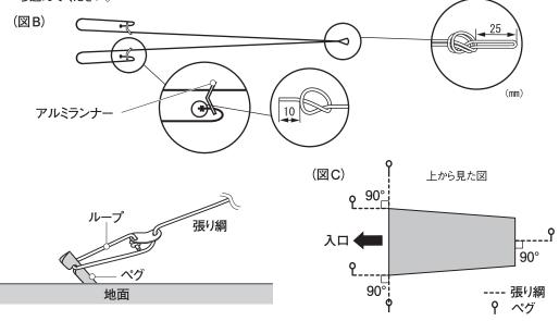
⑤ツェルトポール(別売)は先端にツェルト本体の固定用リング、張り綱ループの順に掛け、垂直になるように 立てます。ツェルトポールの代わりに、お持ちのトレッキングポール(ストック)等を使用することもできます。
