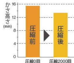
JIS L1096:2010 圧縮処理:アムスラー型試験機を使用(3kg荷重)
