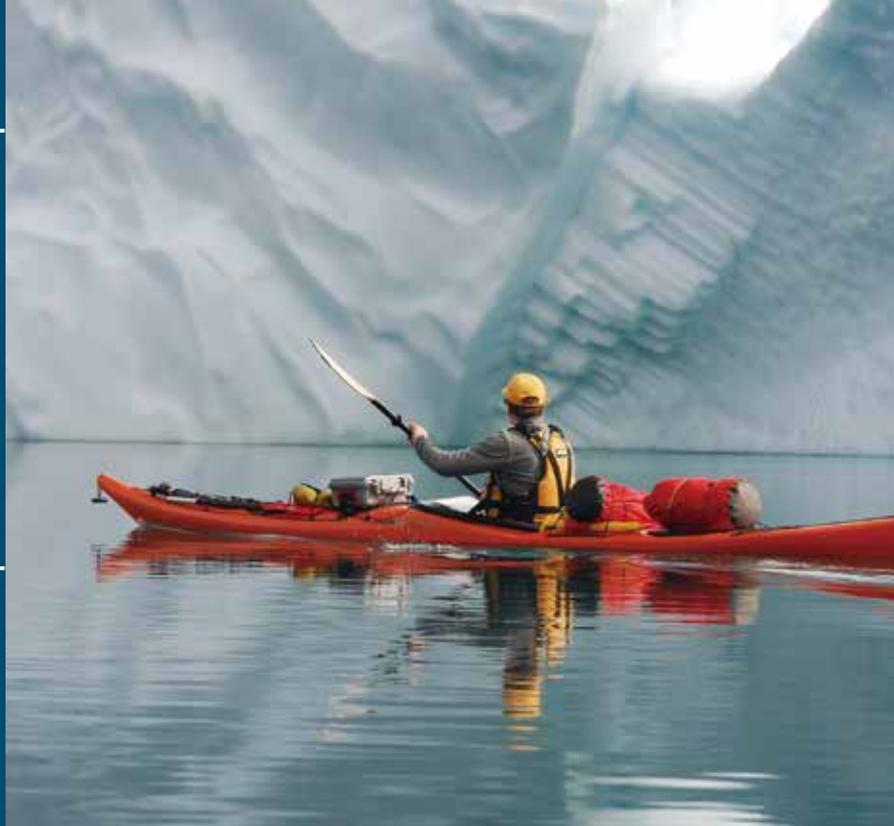
シーカヤックは細く長い形状をしており、高い速度性能と直進性、十分な量のキャンプ用品などを収納できる荷室、進路保持を補助する装置を備えています。海や湖・大河などの長い距離を速く効率よく進むことができ、ショートツーリングに適したモデルとロングツーリングに対応するモデルがあります。
