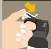
セーフティークリップを「カチッ」と音がするまで押し込み、外れないよう固定し、誤噴射を防ぐ。
