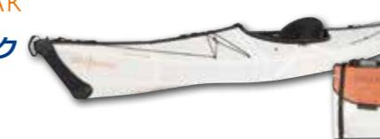
1枚のポリプロピレン製シートを折り紙のように折り組み立てる構造。フレームを必要としないシンプルな構造の軽量・コンパクトに携行できるカヤックです。
