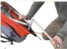
フレーム最後部のテンションバーに船体布のコードを引っかけてバーを引き起こします。
