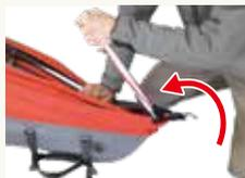
前方へ倒すことで船体布と艇全体にテンションがかかり、船体に張りが生まれ、ベストフィットの状態が作れます。
