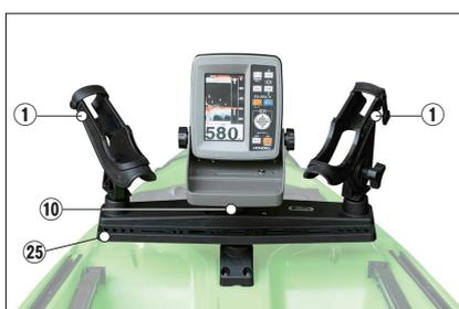
シート前方のスペースにロッドホルダー2基と魚群探知機のモニターを固定した例です。⑳トリプルロッドホルダーを介することで、1つのベースマウントで、3つのアイテムを固定することができます。
