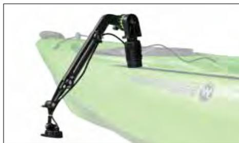
魚群探知機のセンサーを標準装備のレールを使用し固定した例です。⑩スリップディスクを使用することで、少しネジをゆるめるだけで、上げ下げが可能です。
