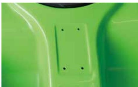
位置を決めたら、マーキングをした箇所にドリルを使い穴を開けていきます。埋め込みタイプのマウントは、ホールソーに付け替えて穴を開けます。※穴の径や角度を十分に確認し慎重に開けてください。
