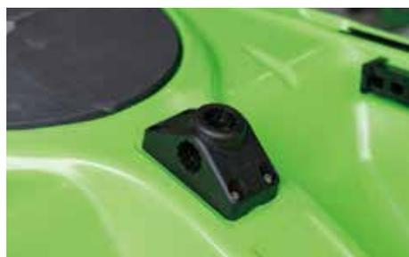
留め具を使用しマウントを固定します。固定の際に防水加工できるものがおすすです。コーキング剤を併用すれば、より防水性が高まります。留め具の種類については下記を参照ください。
