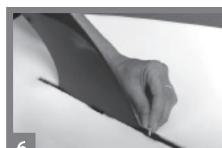
6 フィンのネジ穴と、スチールプレートのネジ穴の位置を合わせます。
