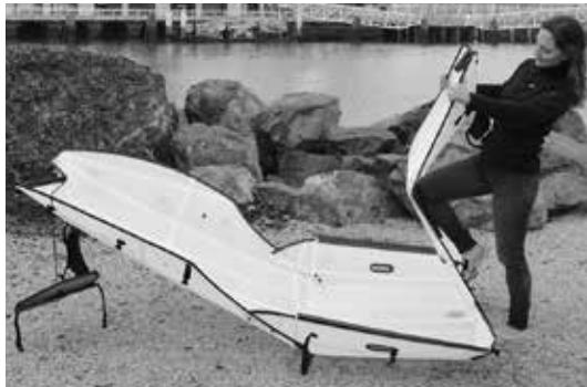
6 写真のように、バウ(船首)とスターイン(船尾)のいずれかを内側に折ります。この際、ひざを使うと折りやすくなります。
