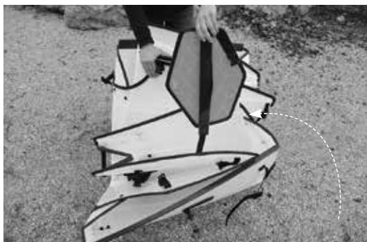
9 フットレストとバウ・バルクヘッドを折りたたんだボートの中に収納します。
