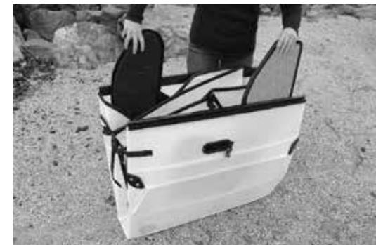
11 シートパッド、シートバック、スターイン・バルクヘッドをボックスに収納します。
