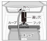
トレールウォーターパック のスライドパーツのフック を荷室内上部、図の黒 色ループに掛けて装着 し、本体側通し穴を通し て荷室の外にチューブを 出します。
