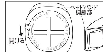
① 電池フタの△をOPEN表示の方向に回して外します。コインやヘッドバンド調節部の端などを中央の溝に差し込み、OPEN表示の方向に回して外します。
