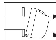
本体を上下に動かし、LEDの照射角度を調節します。
