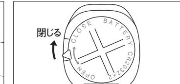
③ 電池フタを元に戻し、△をCLOSE表示の方向に回して締めてください。コインやヘッドバンド調節部の端などを中央の溝に差し込み、CLOSE表示の方向に回して締めます。
