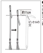
●ご使用のピッケルに 合わせて長さを図のよう に調節します。その際、 調節金具をピッケルの 穴に合わせ、ヘッドルの プが約11cm余るように 調節してください。
