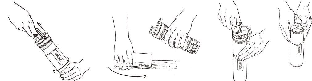
① キャップのハンドルと、アウターボトルを片手ずつ持ち引き抜きます。ひねりを加えると外しやすくなります。
