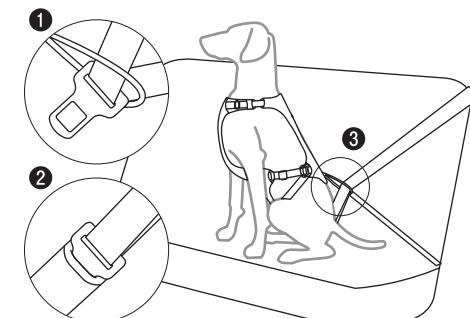
重要：シートベルトは「アタッチメント」ループにのみ固定してください。ハーネスの他の部分にシートベルトを固定しないでください。
