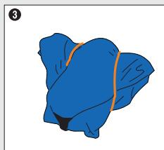
エラスティックループを機器のレンズなどにかけ、コードロックを絞り、調節します。
