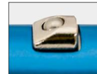
ボタンに傾斜がついており、中央部分にベアリングを設けているため、スムーズな収納が可能。またシャフトの内径に溝が切っており、ボタンを誘導するガイドの役割を果たします。
