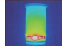
「フラックスリング」が、バーナーの熱を周囲に逃がさずクッカーへ伝達。熱効率が高く低燃費。
