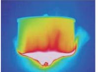
バーナーの熱がカップ周囲に拡散してしまい、熱効率が低い。
