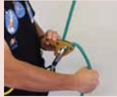
ローダウン時のコントロールもレバーを使ってスムーズに行えます。レバーを戻せばブレーキがかかります。
